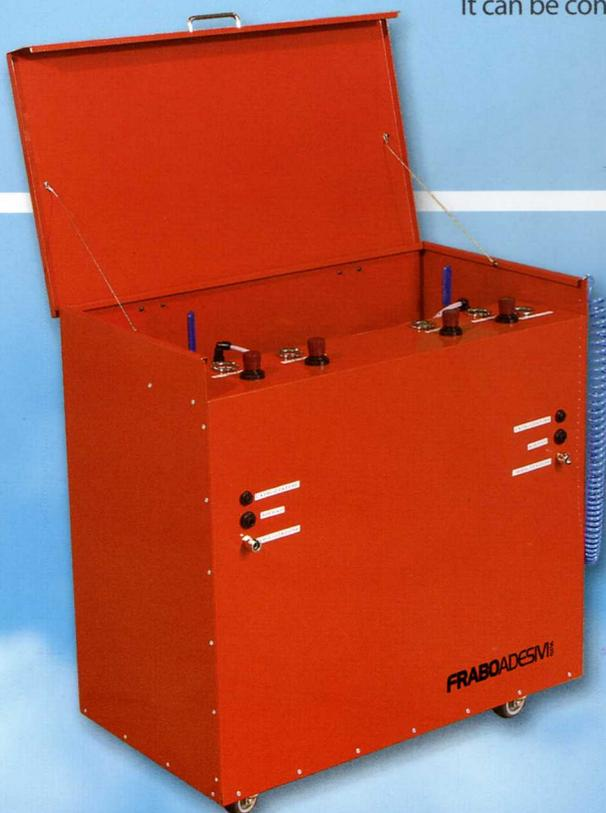
Impianto di spruzzatura standard sottopressione per consumi medi. Il cassone è dotato di ruote per agevolare gli spostamenti. Può essere collegato a due pistole.
